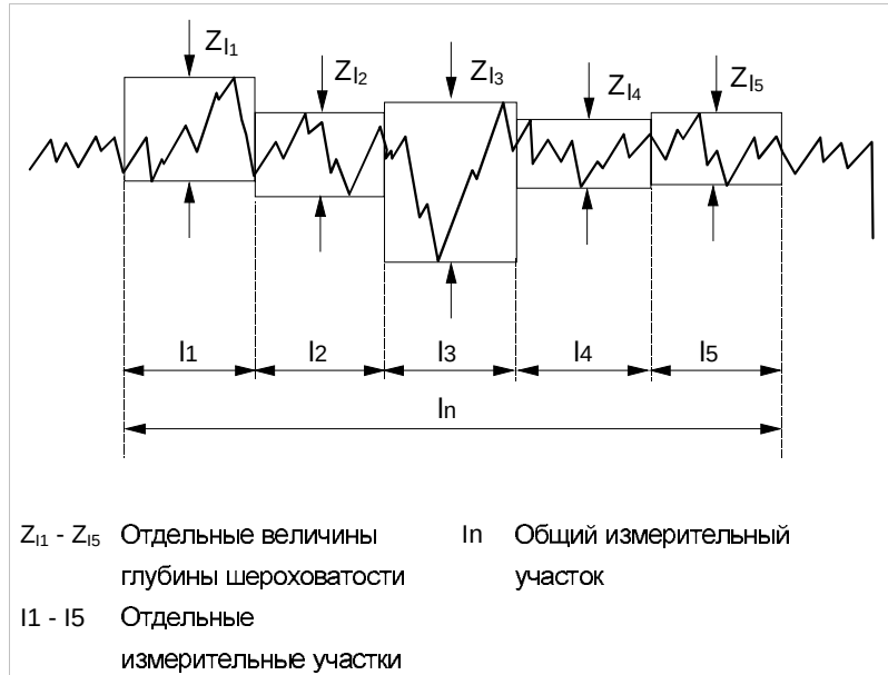
Иллюстрация: Глубина шероховатости на пяти отдельных измерительных участках
