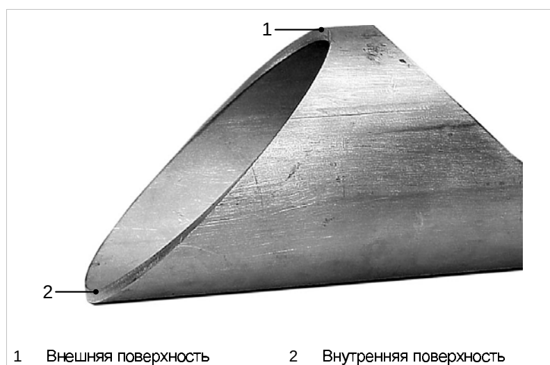
Двухмерная обработка: Ровный рез
