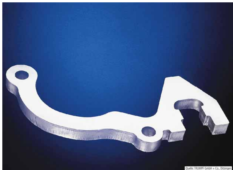
Резка с азотом: Деталь с кромкой реза, свободной от оксидов
