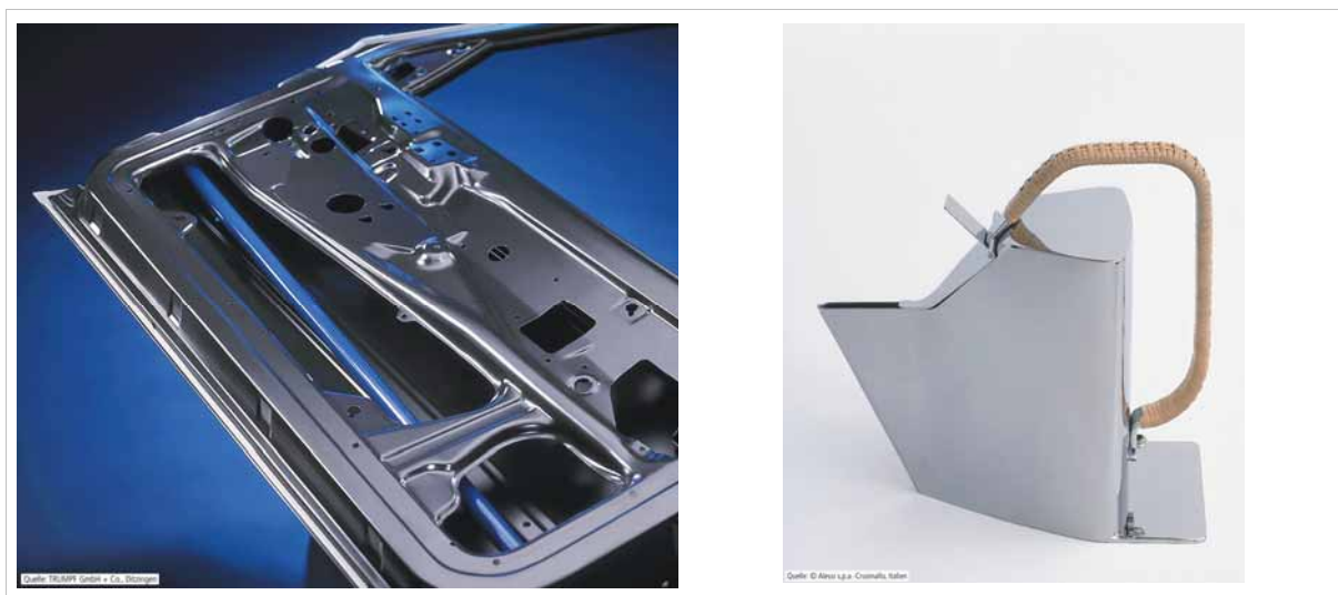
Слева: Вырезанные лазером детали дверцы автомобиля из конструкционной стали Справа: Вырезанный лазером чайник из нержавеющей стали
